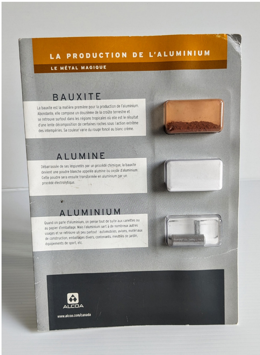
Figure 8.2 Photo d'une plaquette contenant les trois principaux composants intervenant dans la chaîne de production de l'aluminium
