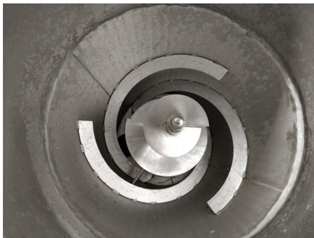
Figure 3.24 Rotor hélicoïdal d'un pilote de pâtes et papiers au Cégep de Lévis
