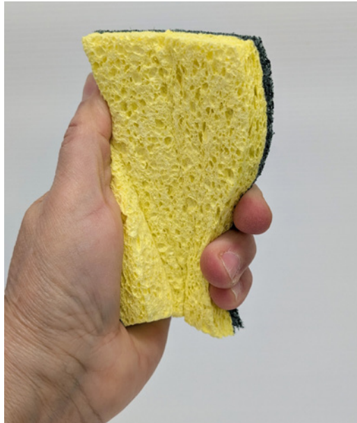
Figure 5.8 Reprise de la forme des élastomères après compression
