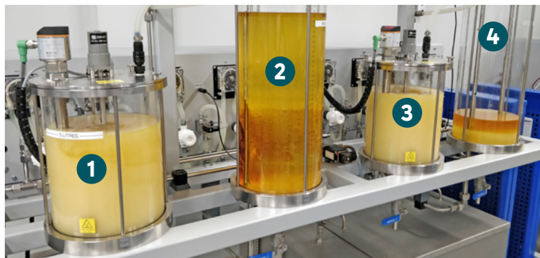
Figure 4.9 Séparation de phases lors de la transestérification partielle de l'huile de canola avec le méthanol et l'hydroxyde de potassium dans les laboratoires du programme Techniques de procédés industriels du Cégep de Lévis (1 et 3 = réacteurs de transestérification; 2 et 4 = décanteurs de phases)
