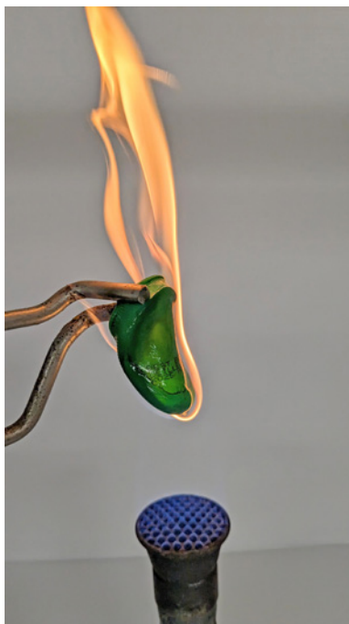
Figure 5.6 Ramollissement des thermoplastiques
