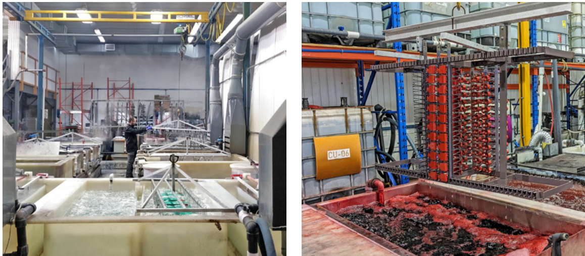
Figure 8.5 Bassins industriels d'anodisation et de coloration (la photo de gauche a été prise à Almaho inc., à Lévis; celle de droite, à AnodiQ inc., à Saint-Nicolas)
