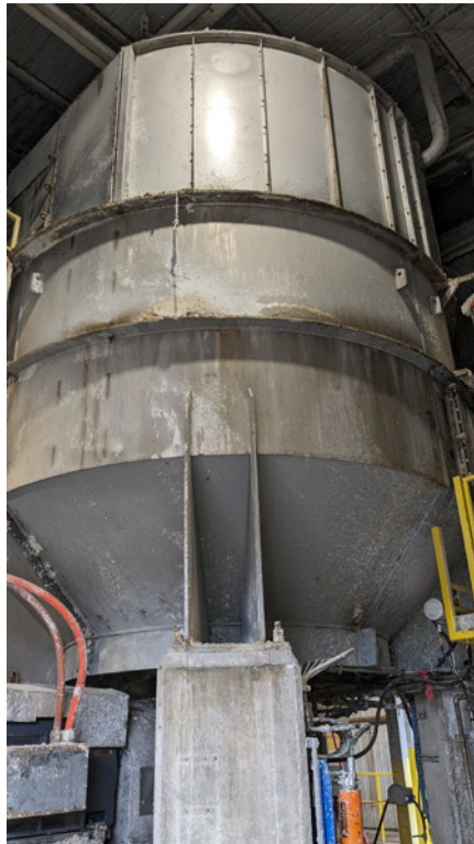
Figure 3.23 Tritrateur industriel à l'usine Fibres Sustana de Breakeyville
